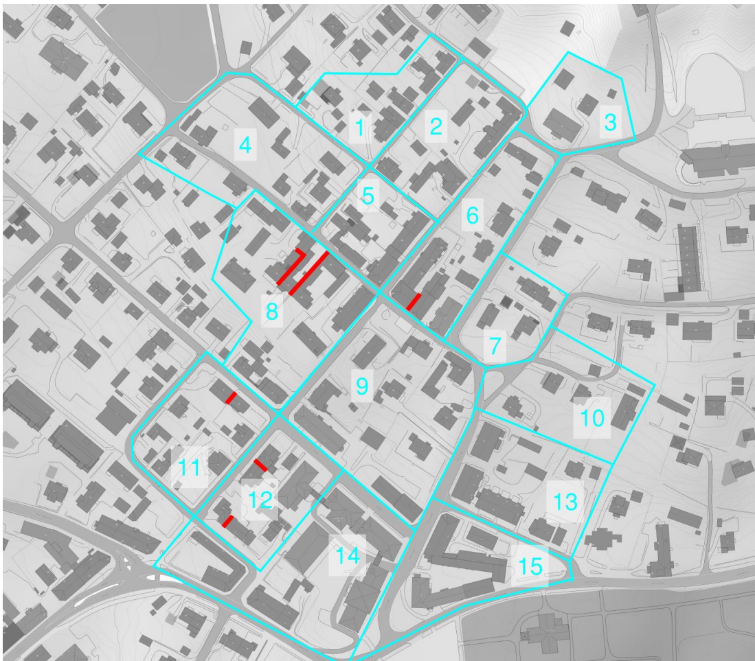
Figur 10: Illustrasjonen viser brannvegger i bebyggelsen med rød strek og soneinndelingen som også er beskrevet i kapittel 4.2.
