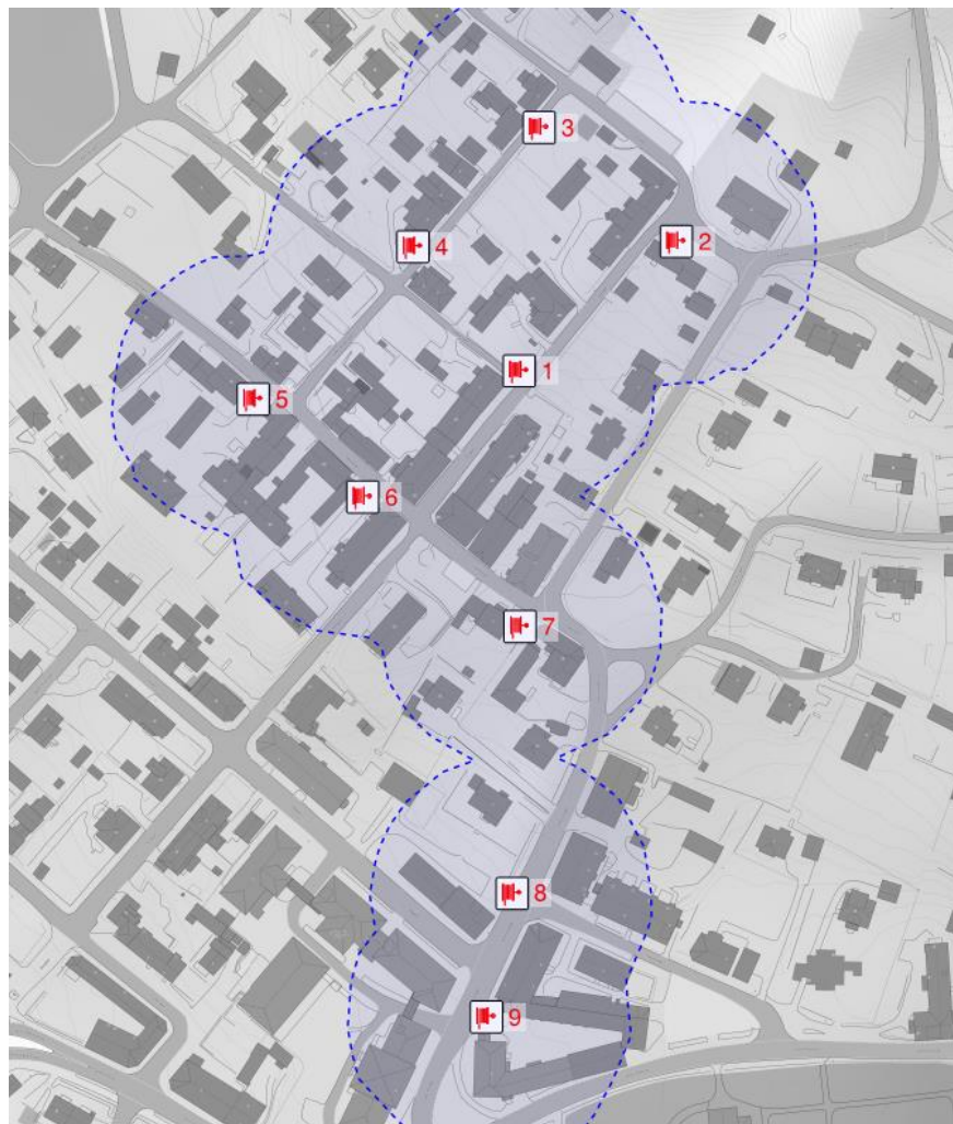
Figur 11: Plassering og nummerering av brannslangeposter. Blå skravur viser dekningsområde ut fra antatt rekkevidde på 50 meter.
