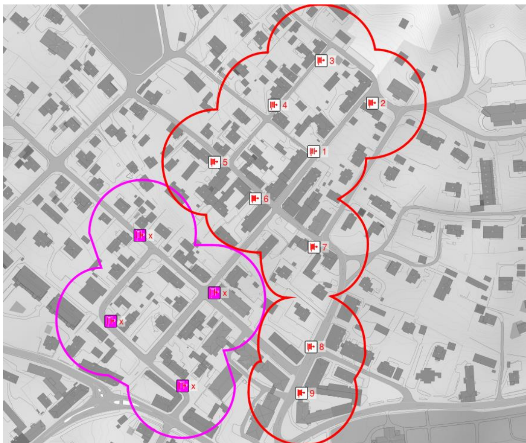
Figur 19: Rødt område viser antatt dekningsområde for dagens slokkeposter. Det anbefales å installere nye slokkeposter slik at rosa område dekkes.
